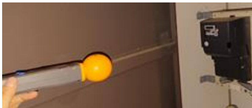
図. スマートメータと測定の様子
