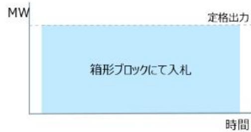
<系統制約等の出力制約がないバランス停止機>
